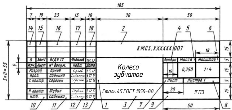
Рис. 1.12. Основная надпись производственного чертежа
